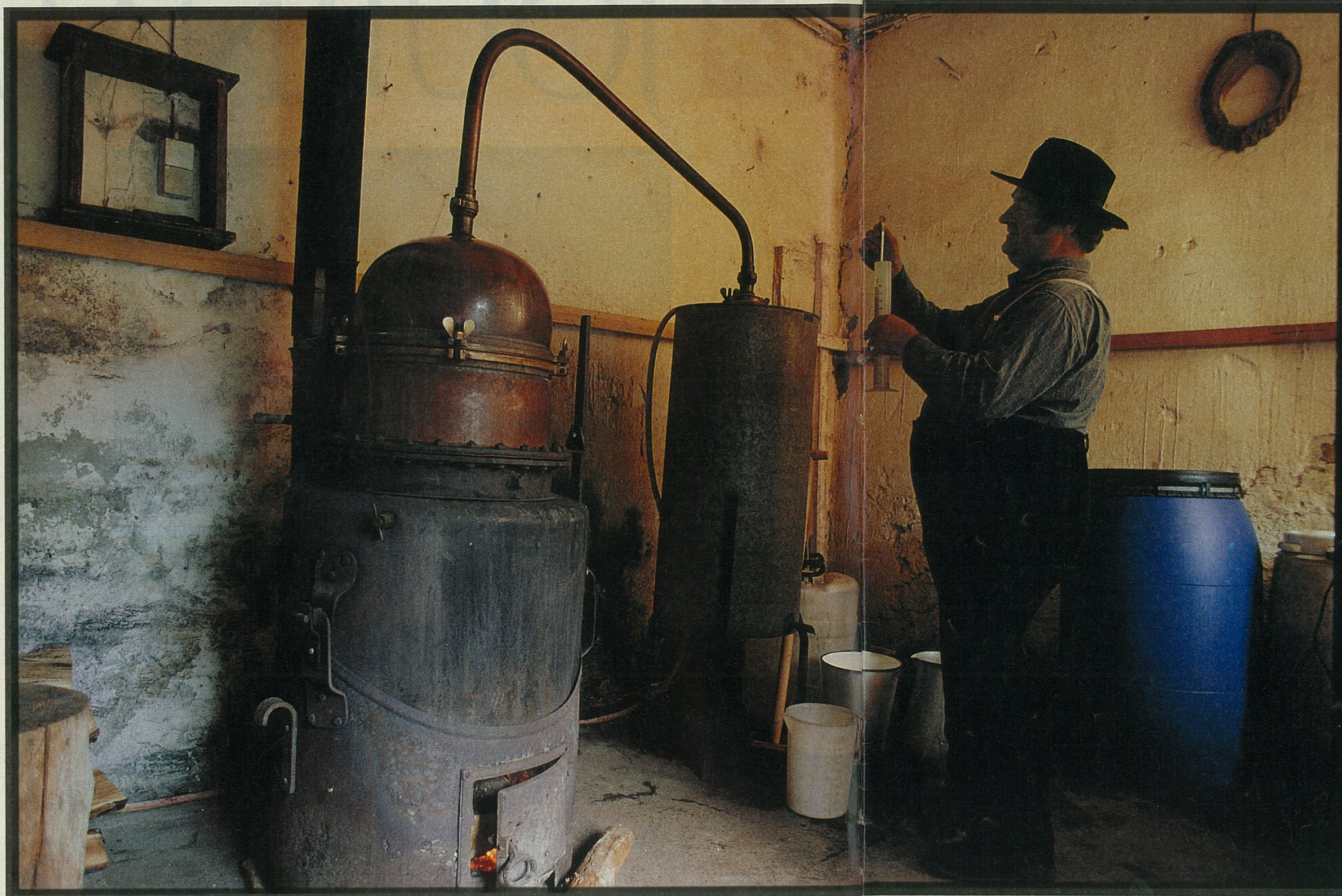
Zwischen Brenner und Kühler ein Blick aufs Alkoholometer. Das zeigt Armin an, wie rein sein Schnaps ist
